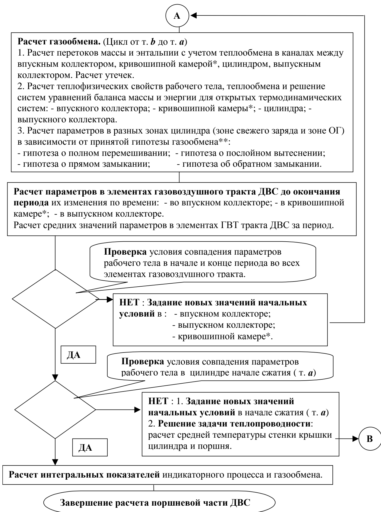
Рис. 2.15. Блок схема программы расчета поршневого ДВС (окончание);
